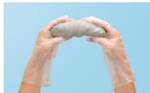
混合色がグレーになれば接着や穴埋めをする部分に塗り付け、硬化するまで静止してください
